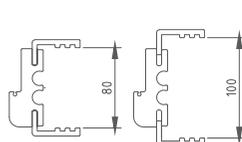
ESPESOR MÍNIMO DE MURO AJUSTABLE DE 80 MM A 100 MM
